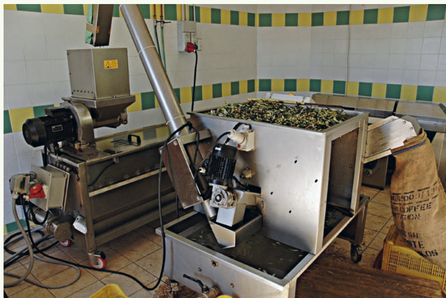
Foto A - Particolare del prefrangitore utilizzato nell'impianto di estrazione utilizzato per le prove sperimentali
