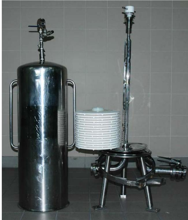
**Figura 13.1** – Esempio di housing per i filtri lenticolari utilizzati per la filtrazione in linea dell'olio extravergine. Dimensione della campana, numero di unità filtranti ed intensità di filtrazione dello strato possono e devono essere modulati in funzione del tipo di prodotto in entrata e alle esigenze (portata, durata, intensità di filtrazione) del frantoio
