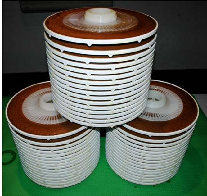
**Figura 13.2** - Filtri lenticolari utilizzati per la messa a punto del sistema di filtrazione in linea all'interno del frantoio sociale del Grevepesa
